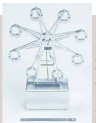
輪の部分も切削で仕上げている観覧車
